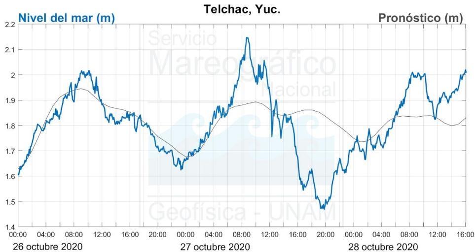
**Figura 6:** Registro del sensor de nivel del mar de la estación de Telchac, Yuc. El eje horizontal corresponde al tiempo y el eje vertical corresponde a la unidad del sensor. La línea color negro indica el pronóstico de marea astronómica.
