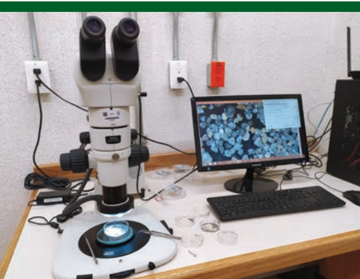
Microscopio petrográfico y estereoscópico para análisis de muestras.
