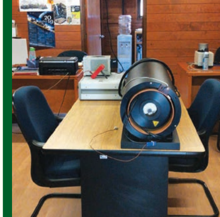
Desmagnetizador térmico utilizado en estudios paleomagnéticos y arqueomagnéticos.
