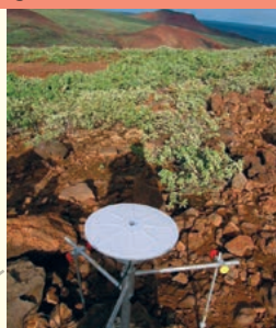
Magnetómetro Ruska para declinación e inclinación magnética.
