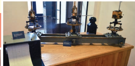
Tambor registrador con reloj eléctrico (para producción de magnetogramas c/24 hrs.) marca Ruska 1955; y conjunto de variógrafos para medir tres componentes del campo magnético, marca Askania, (1939), Museo de Geofísica.
