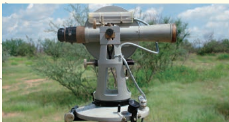
Magnetómetro Ruska para declinación e inclinación magnética.
