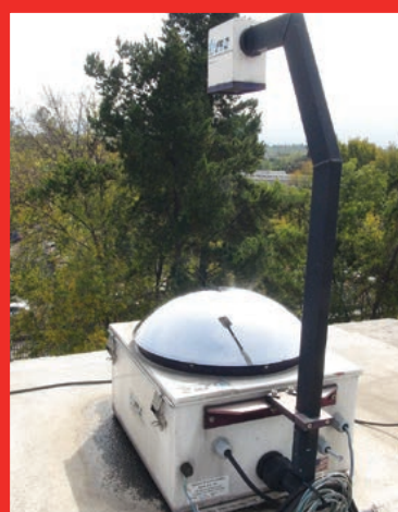
Cámara de condiciones atmosféricas de bóveda celeste (skycam), Observatorio Central en Ciudad Universitaria, CDMX.
