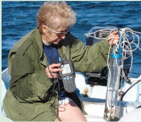
Muestreo de agua en zona de ventilas termales someras en las costas del Golfo de California. Proyecto "Evaluación de los recursos geotérmicos de la Península de Baja California: continentales, costeros y submarinos"
