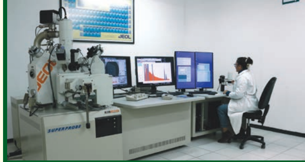
Laboratorio de Microanálisis, Microsonda Electrónica (EPMA) empleada para el análisis elemental cuantitativo y cualitativo a escala micrométrica.
