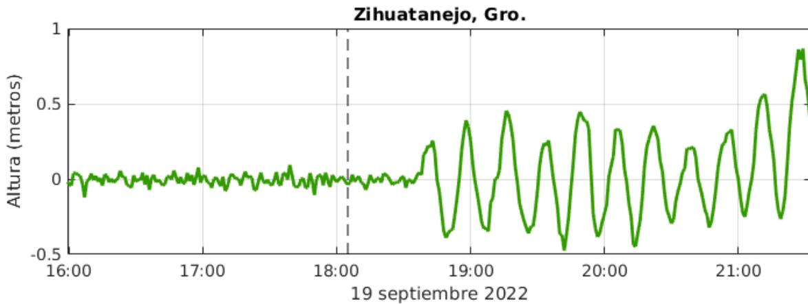
**Figura 12.** Residual (datos medidos - pronóstico de marea astronómica) calculado en la estación de Zihuatanejo, Gro. El eje horizontal corresponde a la fecha y el eje vertical a las alturas, donde cada rectángulo representa una altura de 50 cm. La línea en color negro corresponde a la hora de ocurrencia del sismo.
