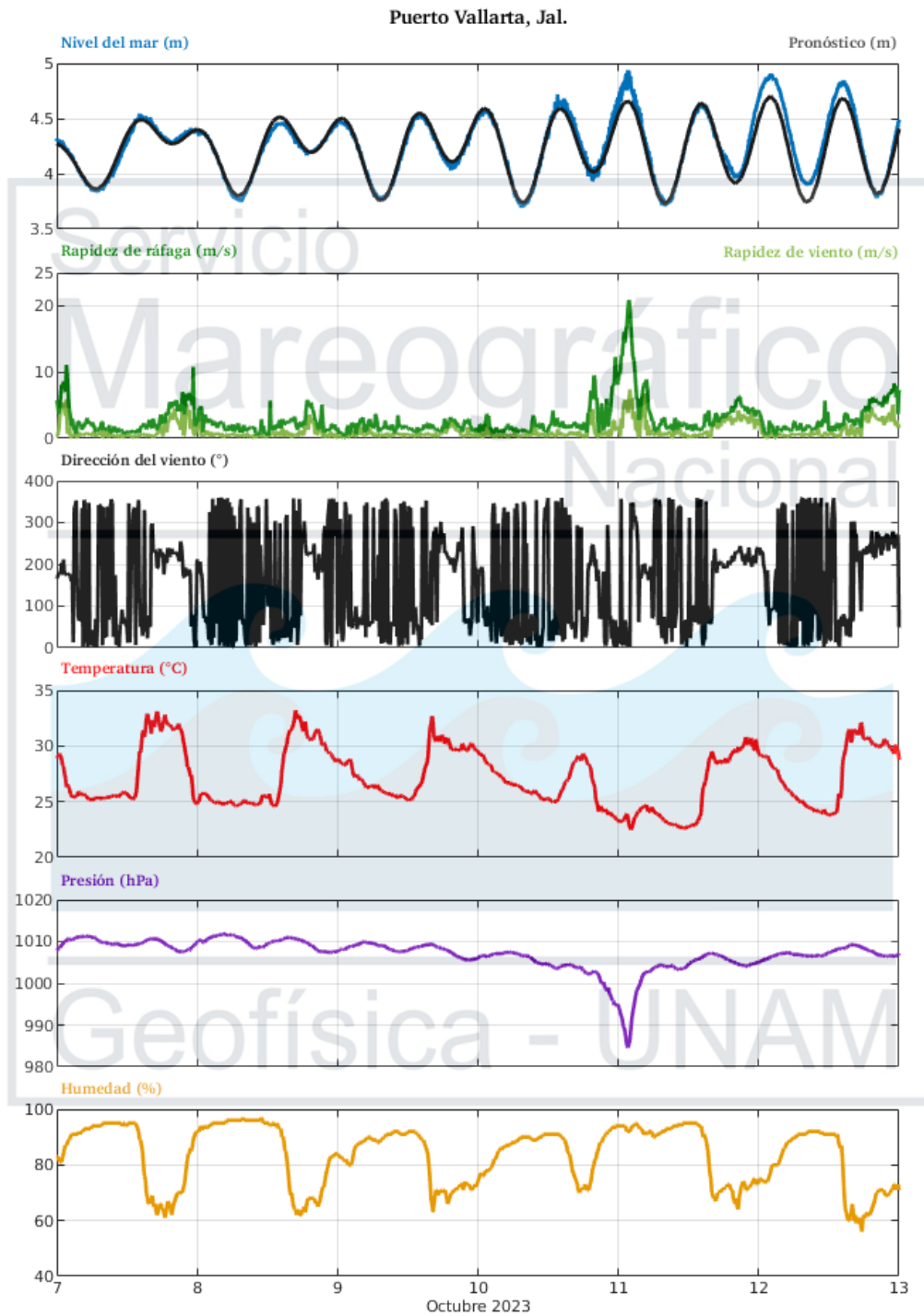
Figura 12. Registro del sensor de nivel del mar y sensores meteorológicos de la estación de Puerto Vallarta, Jal. El eje horizontal corresponde al tiempo UTC y el eje vertical corresponde a la unidad del sensor.
